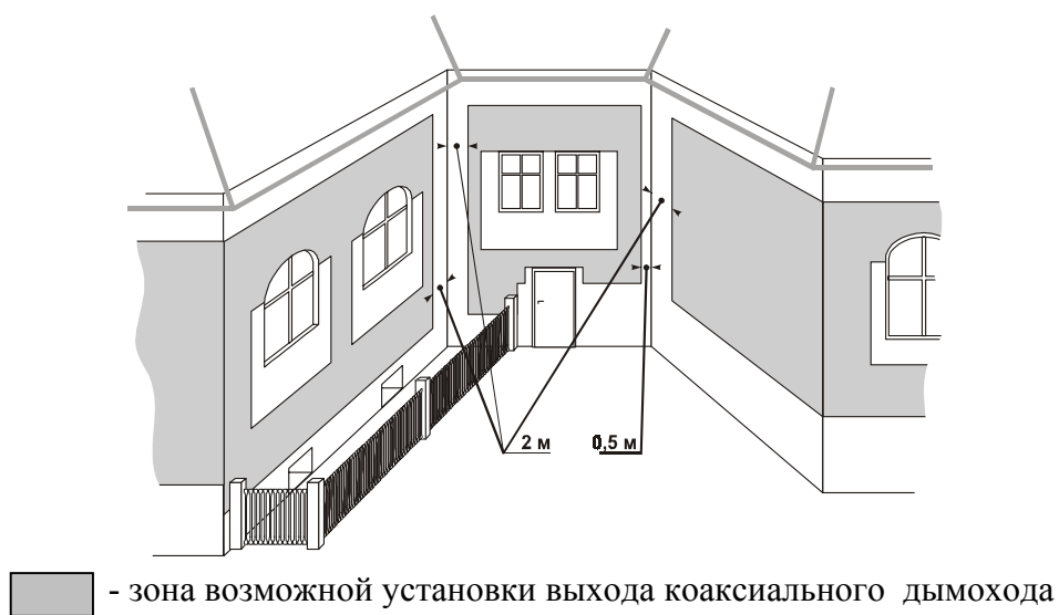
Рисунок 9 – Размещение выхода коаксиального дымохода на фасаде здания
