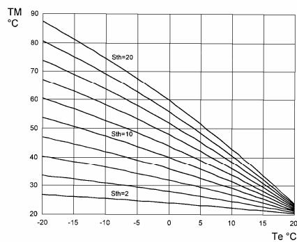
График 2      TM = температура воды на подаче в контур отопления
