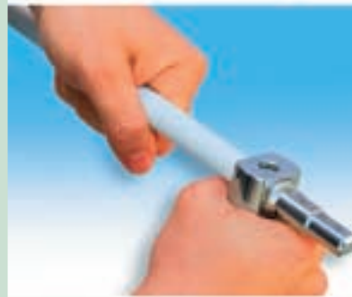
Рис. 2. Калибр соответствующего диаметра вставьте в трубу до упора. Придайте поперечному сечению трубы круглую форму — это облегчит процесс вставки трубы в фитинг. Наличие заусенцев на конце трубы не допускается, т.к. может привести к негерметичности соединения. Одно из преимуществ системы PRESSFAR, существенно сокращающее время монтажа, — отсутствие необходимости снятия фаски с трубы.
