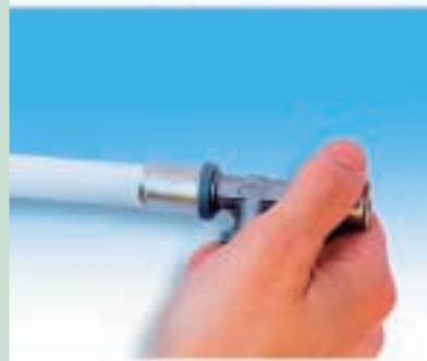
Рис. 3. Установка пресс-фитинга на трубу производится без использования силиконового масла, т.к. оно уже нанесено на поверхность штуцеров. Проконтролируйте, чтобы труба вошла в фитинг до упорной точки — ее должно быть видно через все шесть отверстий на пресс-гильзе.
